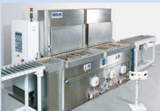
Typ R 540 WSST-US: Rollenbahn, Waschen mit Bodenschall, Spülen zweifach, Trocknung, Oszillation, Rollenbahn
