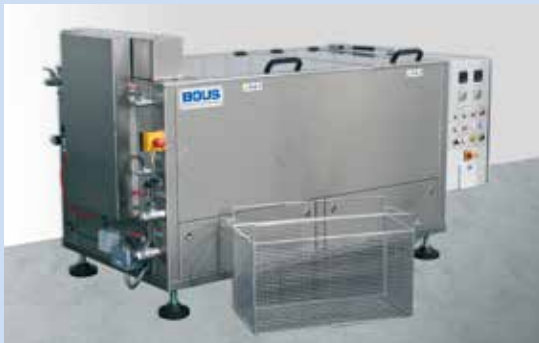
Waschen mit Seitenschall und Oszillation, Spülen, Trocknung
