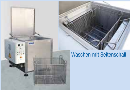
Waschen mit Seitenschall und Oszillation, Spülen, Trocknung
